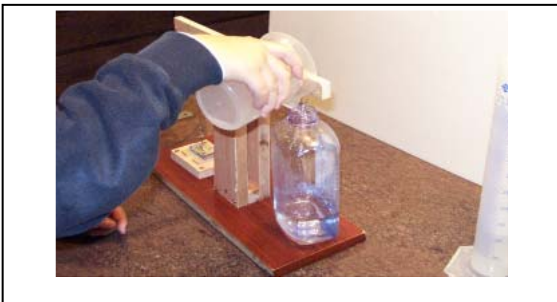
圖 5-4 加水直到磁鐵脫離
