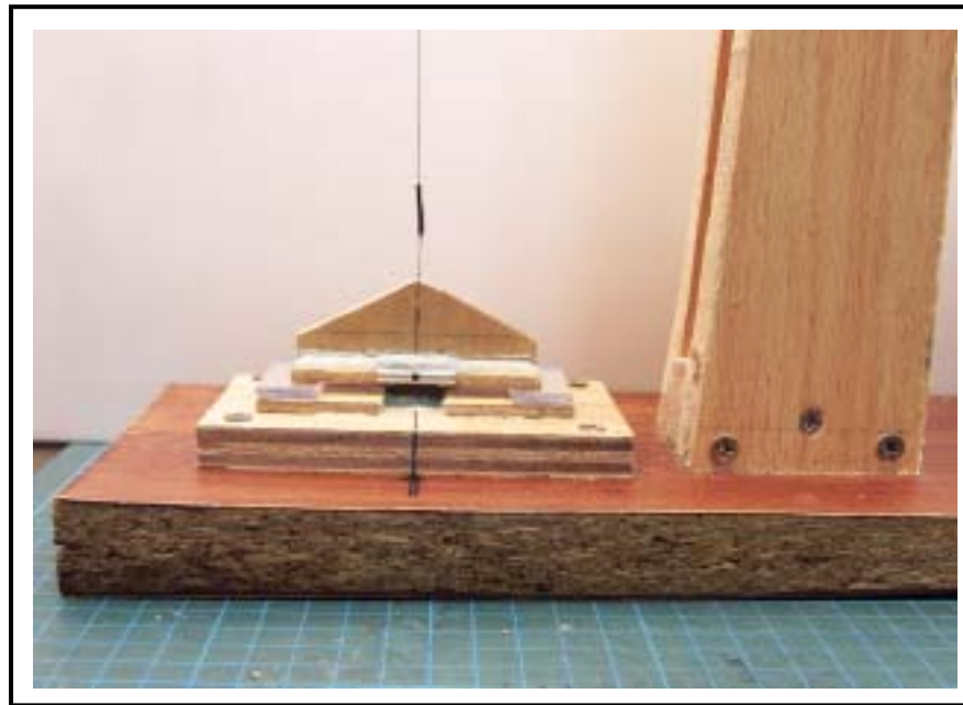
圖 5-3 加上間隔墊片架高磁鐵與鐵片的距離
