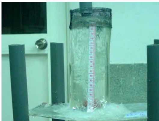
<圖 1> 水流較小時，無法帶動底部物體
