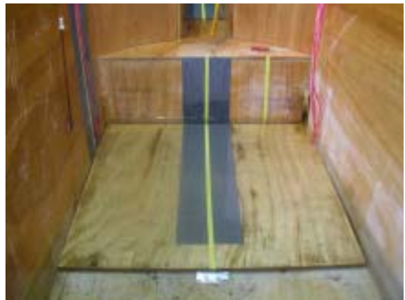
圖十 大水槽加斜板，釘上水砂紙和皮尺
