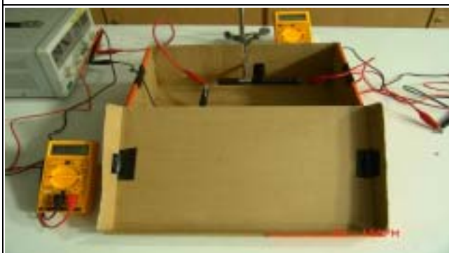
自製微型比色計全貌 (置於鞋盒中避免外界光線干擾實驗)
