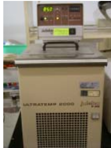
照片十二：水浴槽
