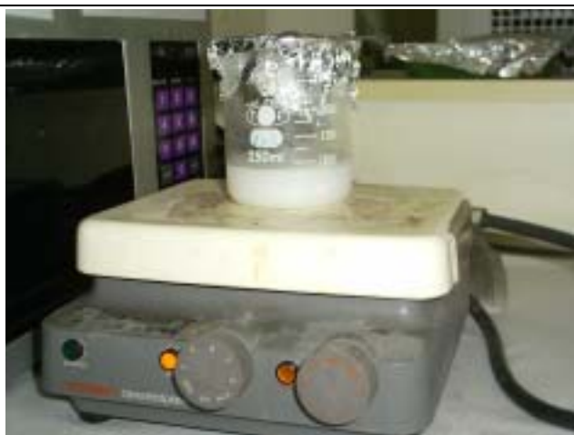
照片五：加入 T.C.A.，攪拌一小時， 使部分蛋白質沉澱
