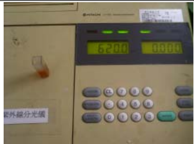
照片十四：紫外線分光儀(分光光度計)
