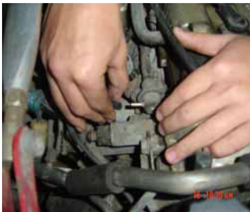
圖五 汽車進氣歧管真空接頭
