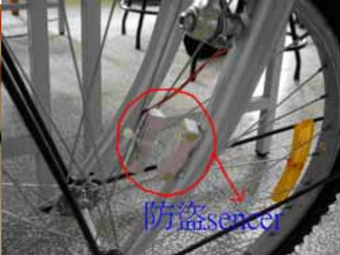
電子防盜與車速之 Sensor： 磁簧開關
